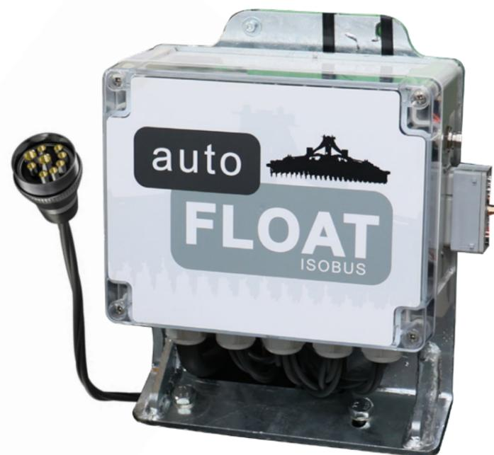
Pour la fonction position flottante, les chambres d'huile de Les vérins hydrauliques sont connectés électriquement à la conduite du réservoir. Les vérins peuvent ainsi se déplacer librement. Pour que les vérins puissent à nouveau travailler, il faut que les électrovannes soient refermées. C'est précisément cette fonction qu'assure automatiquement autoFloat. Des capteurs enregistrent quand la position flottante est activée ou désactivée.
