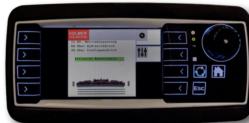
Les informations importantes du déchaumeur à disques peuvent être affichées dans la cabine du véhicule via ISOBUS. Si aucune connexion ISOBUS n'est disponible, ces informations peuvent également être affichées via un câble de données avec un écran séparé. Si aucune des options précédente n'est disponible, le système peut également fonctionner de manière totalement autonome.
